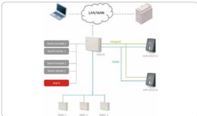
Obr. 28 Konkrétní příklad topologie Aktion KMC/E + MMC vstupových modulů
